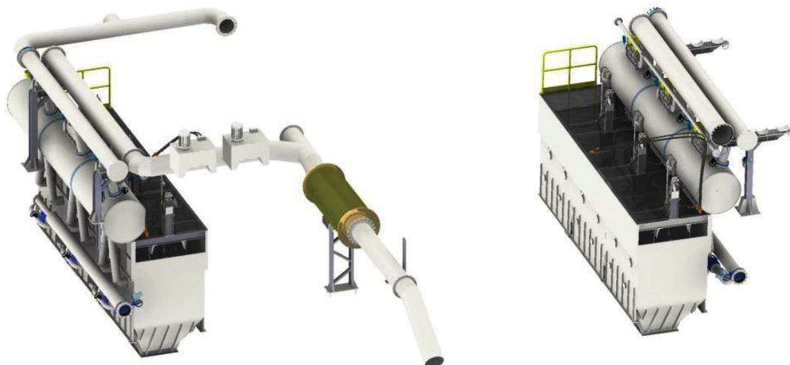
Rys. 8. Osadzarki miałowe OM15L i OM15P KWK Pniówek, po modernizacji [opracowanie własne]
