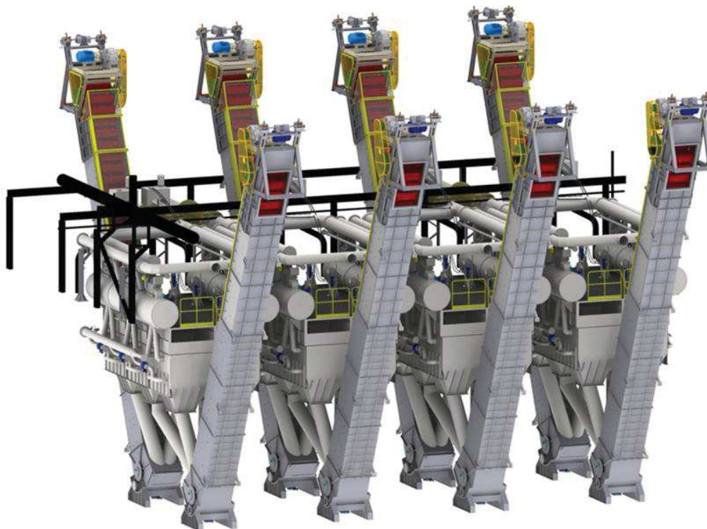
Rys. 7. Węzeł wzbogacania mialów KWK Pniówek po modernizacji [opracowanie własne]
