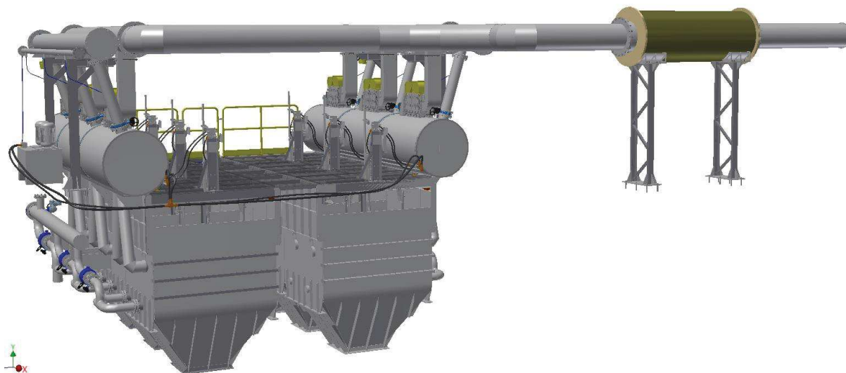
Rys. 16. Osadzarki miałowe OM15L i OM15P ZG „Sobieski” [opracowanie własne]
