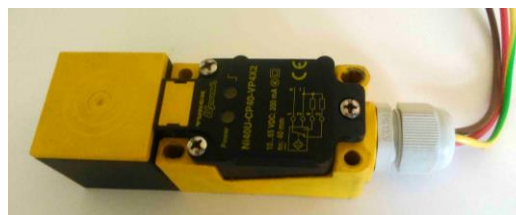
Rys. 5. Widok czujnika indukcyjnego typu TURCK NI40U-CP40-VP4X2-H1141
