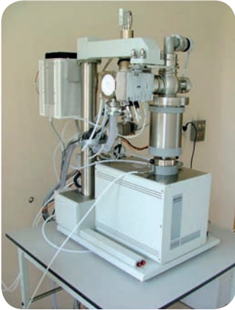
Rys. 1. Zintegrowany system do analizy termogravimetrycznej, różnicowej kalorymetrii skaningowej i kwadрупulowej spektrometrii mas (Netzsch STA 409CD)
