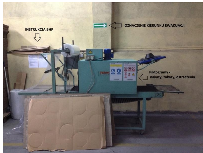
Rys. 4. Magazyn wyrobów gotowych – zgrzewarka
