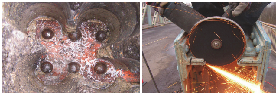
Rys. 1. Weryfikacja zespolenia płyty z dźwigarami i pobieranie próbki stali [12]
