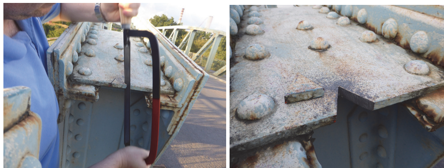
Rys. 2. Pobieranie próbki do badań stali
