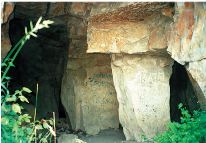
Fot. 9. Komora eksploatacyjna opok w Bochothnicy Fot. 9. The chamber exploitation of opoka in the Bochothnica quarry
