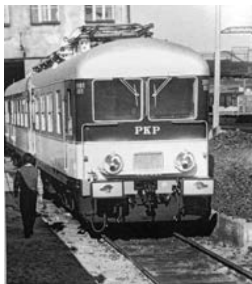
Rys. 6. Wagon diagnostyczny kolejowej sieci trakcyjnej SR61-001 Izabela [12]
