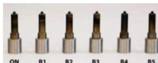
Rys. 4. Wygląd wykorzystanych rozpylaczy po ich pracy w silniku napędzonym olejem napędowym (ON) i pięcioma badanymi mieszaninami biopaliw B1÷B5.
