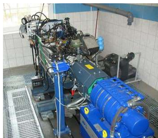
Rys. 3. Pomieszczenie hamowni silnikowej z widocznym hamulcem na pierwszym planie i badanym silnikiem w głębi.
