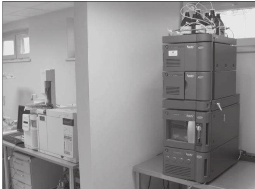
Fot. 5. Pracownia laboratorium interdyscyplinarnego. Na zdjęciu widoczne: na pierwszym planie widoczny aparat do ultrasprawnej chromatografii cieczowej z detekcją fluorymetryczną, na drugim planie chromatograf gazowy ze spektrometrią mas
