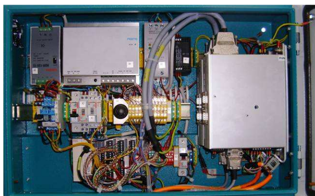
Rys. 11. Rozmieszczenie układu sterowania w sektorze sterownika PLC.
