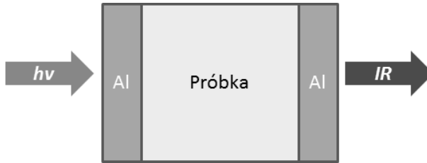
Rys. 2. Trójwarstwowy model fizyczny
