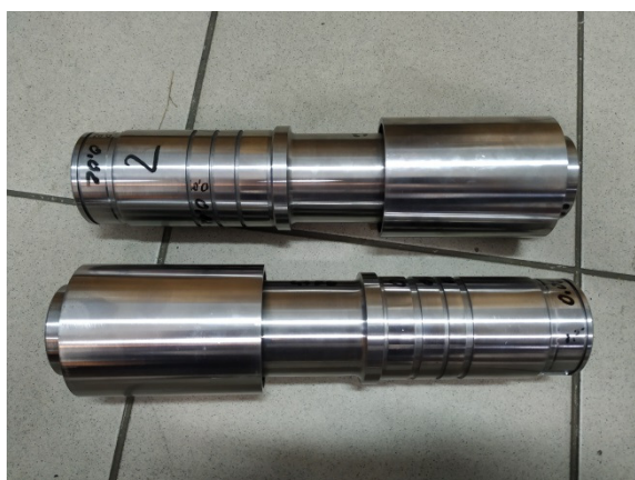
Rys. 4. Zdjęcie zaprojektowanych i wykonanych w INiME KOMEL wirników sterujących, przed naklejeniem magnesów trwałych
