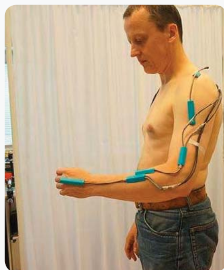
Fot. 1. Sposób naklejenia czujników dla pomiaru wartości kątów w stawie nadgarstkowym, łokciowym i ramiennym z zastosowaniem goniometru (badanie w laboratorium oceny obciążenia układu mięśniowo-szkieletowego CIOP-PIB)
