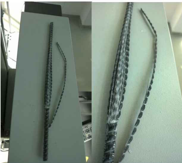
Rys. 5. Pręt BFRP po badaniach wytrzymałościowych
