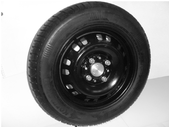
Rys. 1. Widok silnika ETMm-60/12 zamontowanego w kole (widok od strony zewnętrznej)
