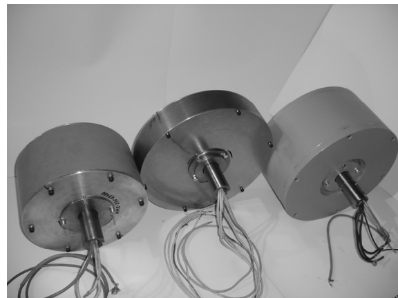
Rys. 4. Silniki (od lewej) typu ETMm-60/12, ETMmt-35/12, ETMm-180/12 (widok od strony mocowania do pojazdu)
