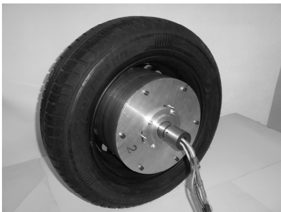
Rys. 2. Widok silnika ETMm-60/12 zamontowanego w kole (widok od strony wewnętrznej)
