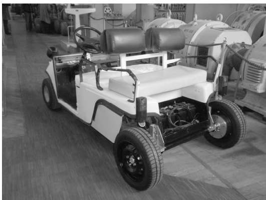
Rys. 5. Pojazd z zamontowanymi silnikami ETMm-60/12
