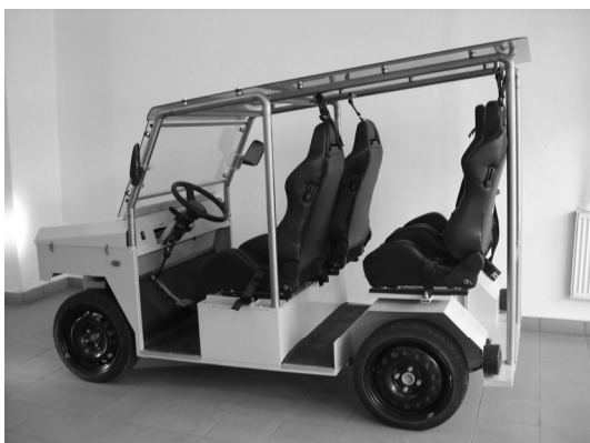
Rys. 6. Pojazd do 1 tony z zamontowanymi silnikami ETMm-180/1
