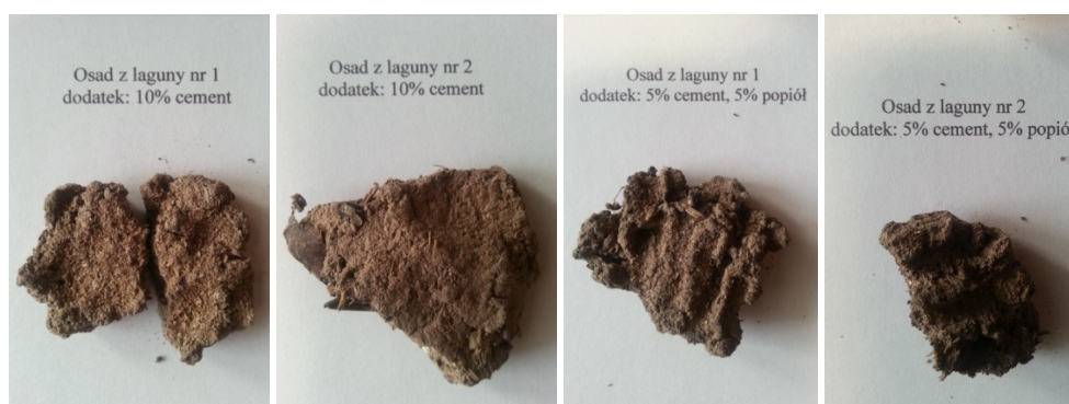
Rys. 4. Konsystencja osadów w wyniku prób zestalania za pomocą cementu oraz mieszanki cement-popiół „powistomowski”
