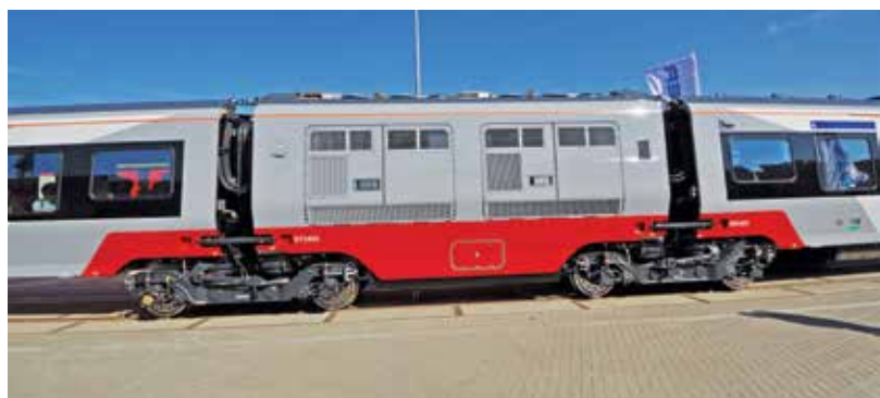
Człon napędowy w zespole Flirt (producent – Stadler) dla przewoźnika Greater Anglia
