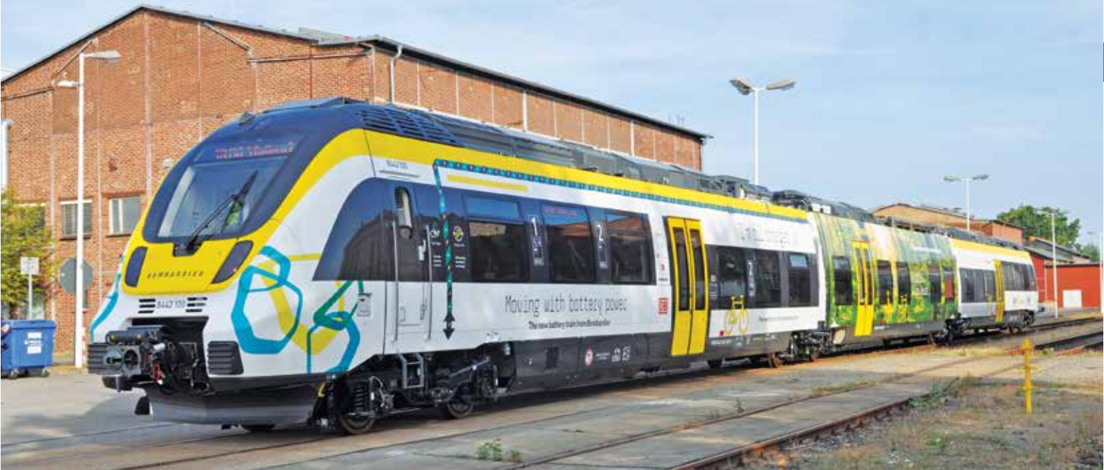
Zespół Talent 3 z zasilaniem bateryjnym na terenie zakładu Bombardiera w Hennigsdorf (20.09.2018 r.) dla przewoźnika NVBW
