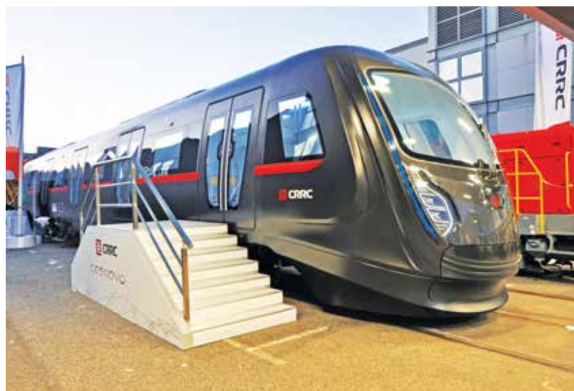
Wagon metra z pudłem wykonanym z włókien węglowych (producent – CRRC)
