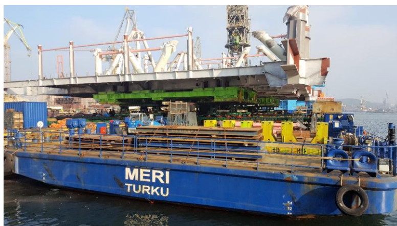
Rys. 1. Przemieszczanie ładunków ponadgabarytowych na statek MERI Źródło: Opracowanie własne.
