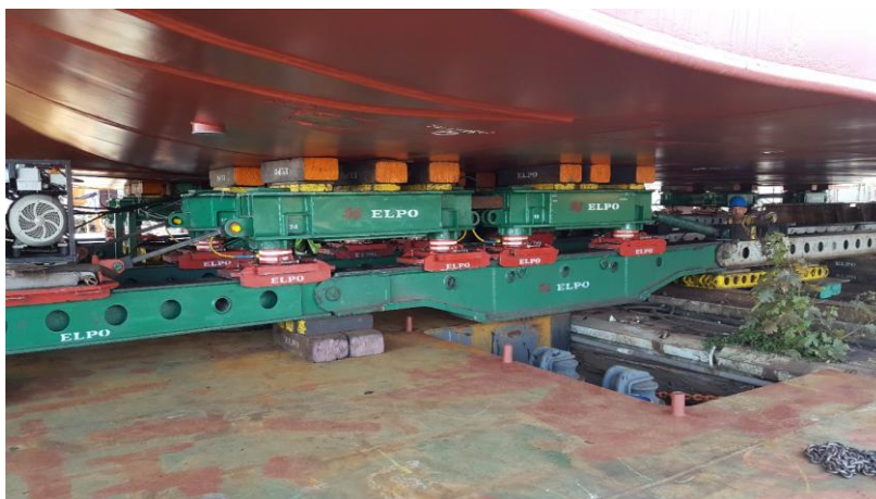
Rys. 2. Transport na wózkach HWS-280 z nabrzeża na ponton ładunków ponadgabarytowych Źródło: Opracowanie własne.
