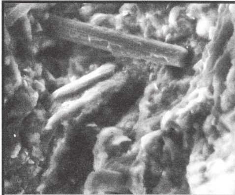
RYS. 1. Kompozyt węgiel-węgiel, 4 tydzień po implantacji, 1150x.
