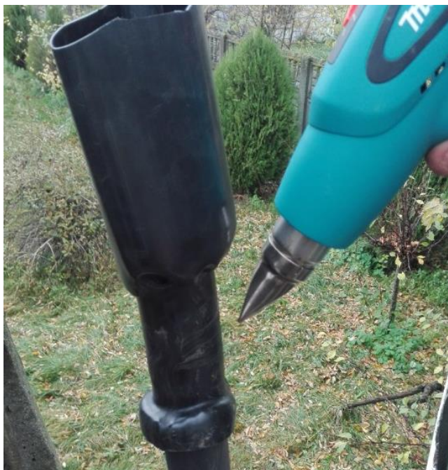
Rys. 29. Opalarka elektryczna firmy Makita do zgrzewania muf i termokurczliwek [fot. Opracowanie własne autorów artykułu]
