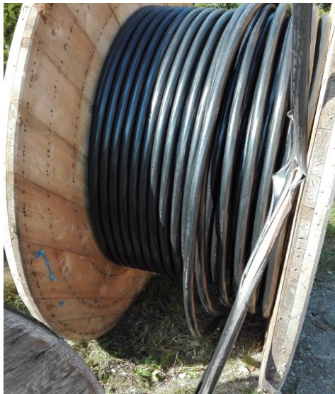
Rys. 1. Kabel 240mm 2 czterożyłowy aluminiowy z izolacją termoplastyczną nawinięty na bęben z widocznym przedarciem izolacji zewnętrznej [fot. Opracowanie własne autorów artykułu]
