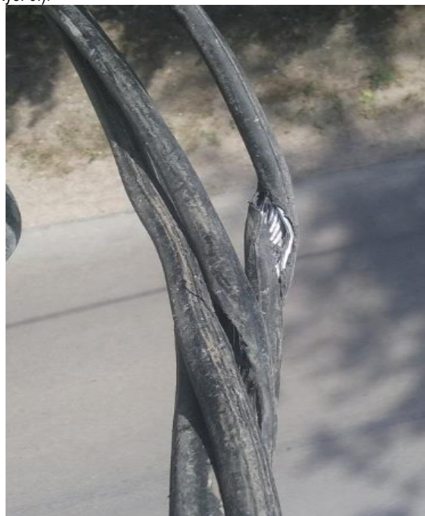
Rys. 6. Mechaniczne uszkodzenie kabla 2 [fot. Opracowanie własne autorów artykułu]
