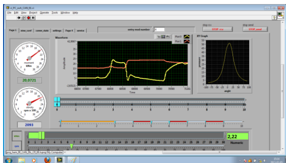
Rys. 5. Widok okna programu sterującego pracą hamowni AMX211
