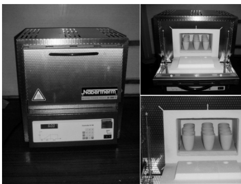
Rysunek 3. Wykorzystywany w badaniach piec muflowy Nabertherm L3/11/B180 wraz z ceramicznymi tyglami Figure 3. Muffle furnace Nabertherm L3/11/B180 along with ceramic melting pots used in the research
