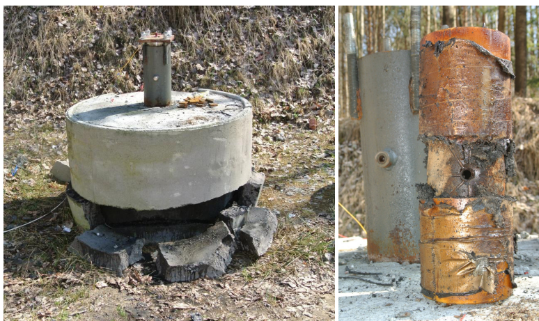
Rys. 9. Wynik testu działania modelowego odcinka perfogeneratora w warunkach zawadnienia
