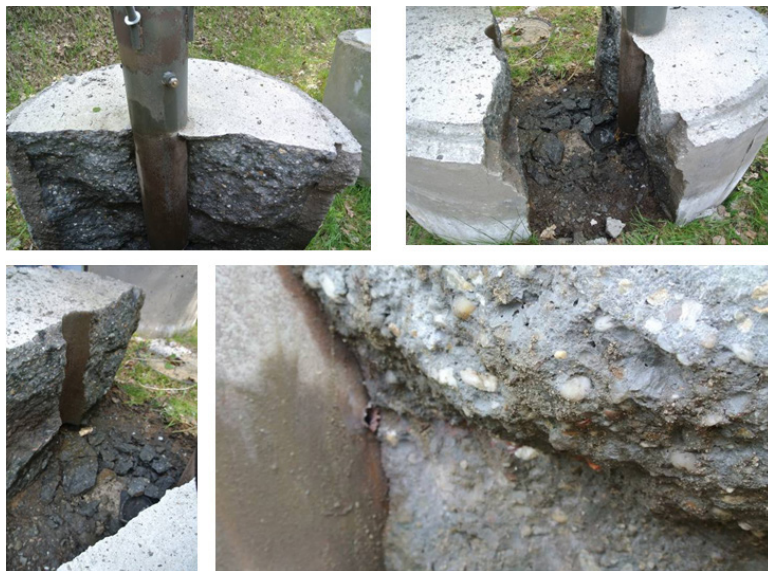
Rys. 12. Wynik testu działania modelowego odcinka perfogeneratora w warunkach zawodnienia (test 3) – pęknięcie i rozczalenie obiektu betonowego na 2 części
