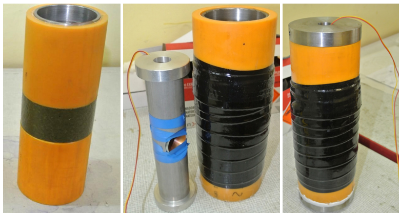
Rys. 7. Przygotowanie modelowego odcinka perfogeneratora do badań w warunkach zawodnienia
