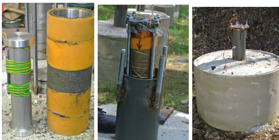
Rys. 11. Widok elementów perfogeneratora oraz jego umieszczenie w rurze okładzinowej imitacji otworu wiertniczego
