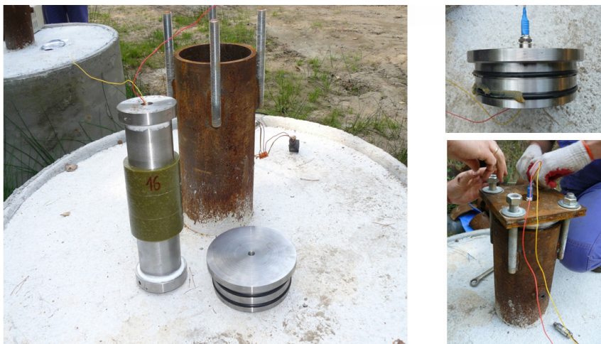
Rys. 5. Stanowisko do testów wersji modelowych nowego urządzenia perforująco-szczelinującego i fazy przygotowań do testu. Widok modelowego odcinka perforatora obok końcówki atrapy otworu wiertniczego oraz etap szczelnego zamknięcia otworu
