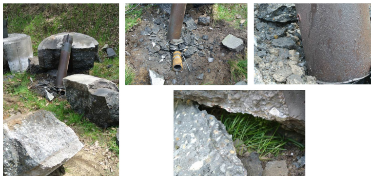
Rys. 13. Wynik testu działania modelowego odcinka perfogeneratora w warunkach zawodnienia (test 4) – pęknięcie i rozczalenie obiektu betonowego na 3 części
