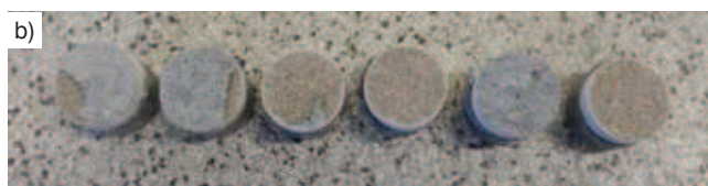
Rys. 3. Oznaczenie przyczepności zaprawy żywiczej do podłoża betonowego metodą pull-off (a), przykład zniszczeń kohezyjnych w podłożu betonowym oraz adhezyjnych w łączu (b)
