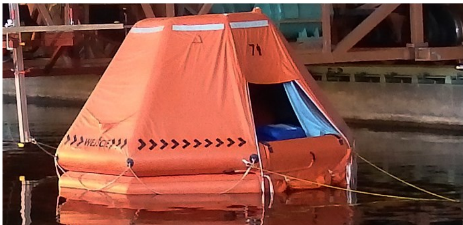
Rys. 4. Tratwa ratunkowa podczas badań oporu na basenie modelowym CTO [Wawrzusiszyn 2015]
