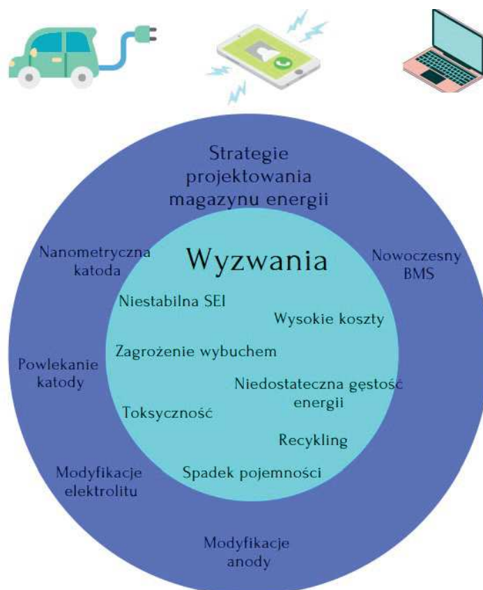
Rys. 10. Wyzwania technologiczne projektowania nowego magazynu energii oraz strategie na jego zaprojektowanie (opracowanie własne)
