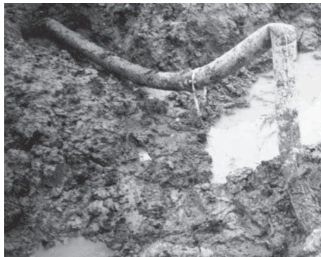
Rys. 11. Wybożenie i zatrzymanie przepływu w rurociągu polietylenowym w strefie ściskania gruntu [4]
