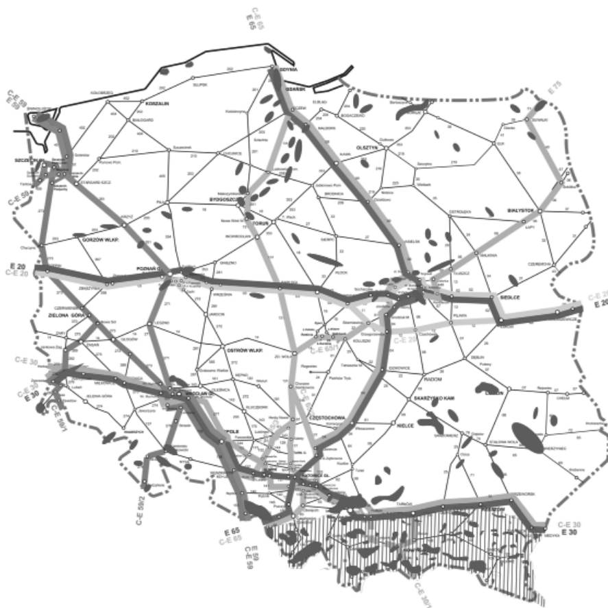
Rys. 1. Rozmieszczenie osuwisk w Polsce a główne szlaki transportowe (zestawiono na podstawie mapy linii kolejowych PLK {15} oraz mapy osuwisk opracowanej przez PIG - PIB {16})
