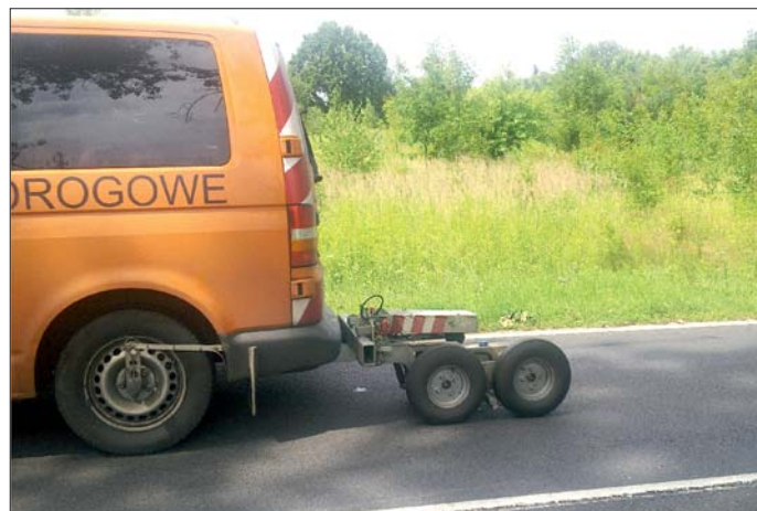
Fot. 2. Urządzenie TWO (Traction Watcher One) produkcji firmy Olsense. Widok ogólny przyczepki do pomiaru współczynnika poślizgowości (tarcia) nawierzchni drogowych i lotniskowych
