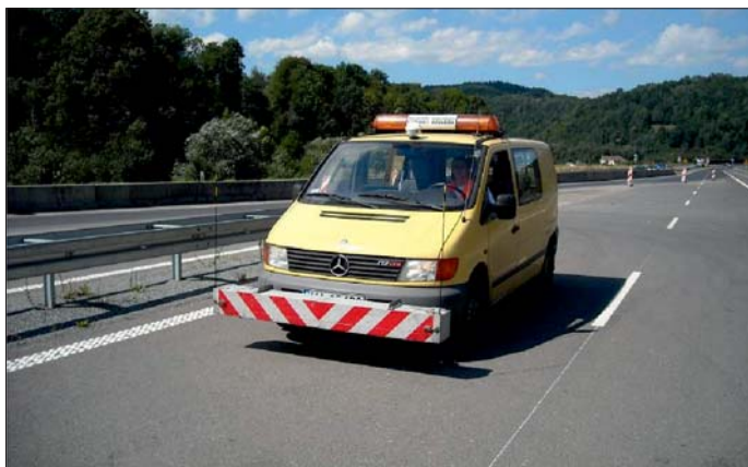
Fot. 1. Profilograf RSP (Road Surface Profiler) produkcji firmy Dynatest
