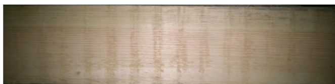
Rys. 1. Fale na desce (ang. washboarding patterns) powodowane utratą stateczności piły taśmowej
