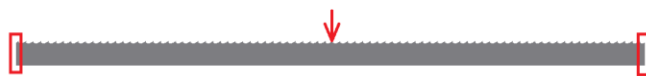
Rys. 1.2.1. Warunki brzegowe podczas analizy utraty stateczności. Czerwone prostokąty oznaczają zablokowane stopnie swobody, czerwona strzałka oznacza obciążenie siłą odporu
