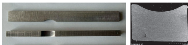
Rys. 24. Próbkę wyciętą na elektrodrażarce przed obróbką szlifowania i wycinek przewężony próbki pobrany do badań metalograficznych
