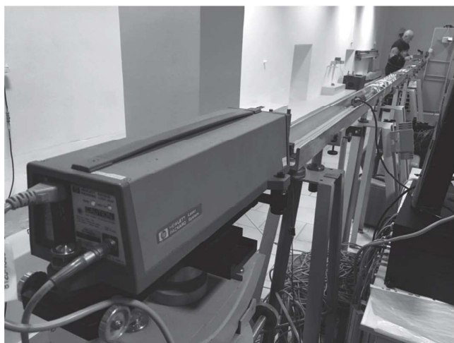
Rys. 4. Komparatorium Geodezyjne AGH. Pomiary kontrolne wskazań sondy ekstensometrycznej
