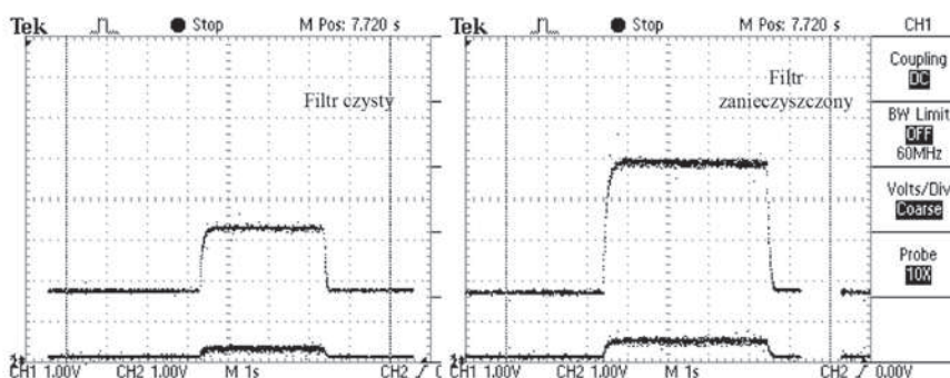
Rys. 11. Zmiany ciśnienia rejestrowanego dla wewnętrznej średnicy otworu oporu pneumatycznego D_{min} = 4,8 mm odpowiednio dla filtra gazu czystego i zanieczyszczonego
