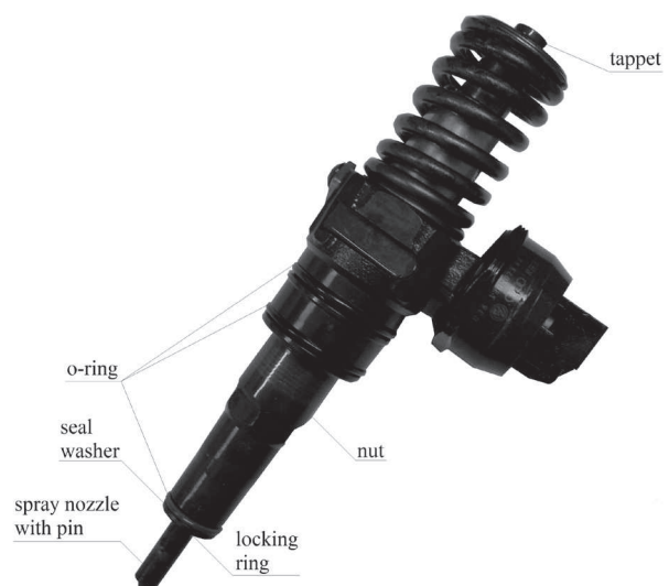
Fig. 5. A view of unit injector system with mentioned elements Rys. 5. Pompowtryskiwacz z wyszczególnieniem wymienionych elementów
