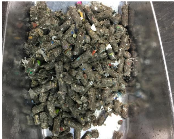
Rys. 2.3 Wsąd do reaktora w postaci peletu RDF ( \varnothing 6mm L max 20mm) o gęstości nasypowej 450 \text{ kg/m}^3 w ZUO Elbląg, źródło: materiały własne – Metal Expert Sp. z o.o. Sp. J.
