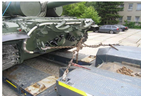
Rys. 3. Mocowanie sprzętu wojskowego przygotowanego do transportu. Źródło: Foto archiwum autora
