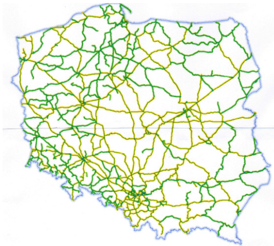
Rys. 2. Rozmieszczenie linii kolejowych w Polsce [4] (kolor żółty - linie zelektryfikowane, kolor zielony - linie niezelektryfikowane)
