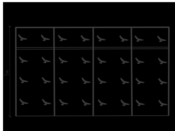
Rys. 2. Niebezpieczny i nieskuteczny układ sylwetek ptaków drapieżnych na przykładzie przeciętnego panelu akustycznego
