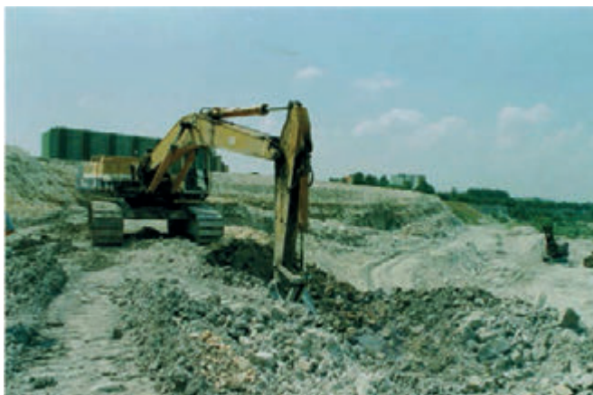
Fot. 5 i 6. Koparka Komatsu PC 400 LC – 5 w trakcie urabiania wapieni
