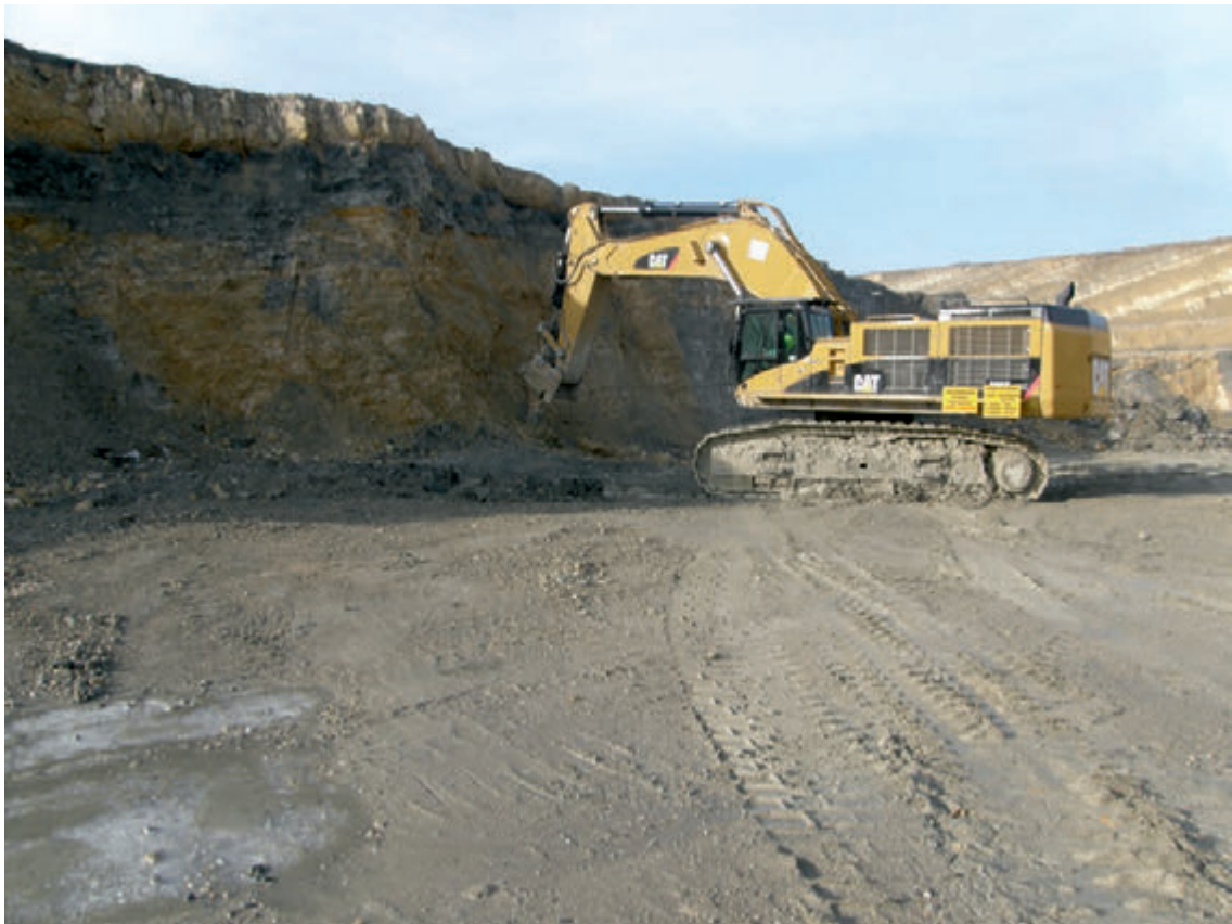
Fot. 10. Koparka Caterpillar ze zrywakiem stałym podczas urabiania wapieni
