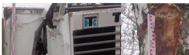
Rys. 6. Widoczne uszkodzenia agregatu chłodniczego wraz z uszkodzonymi rogami kontenera.
