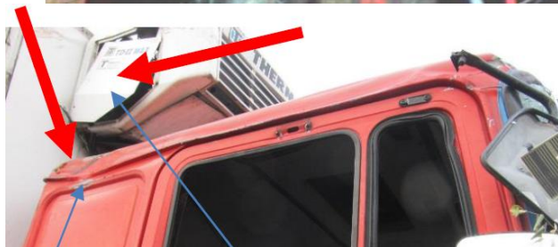
Rys. 9. Widoczne uszkodzenia rogu kabiny wraz z powierzchnią boczną agregatu.
