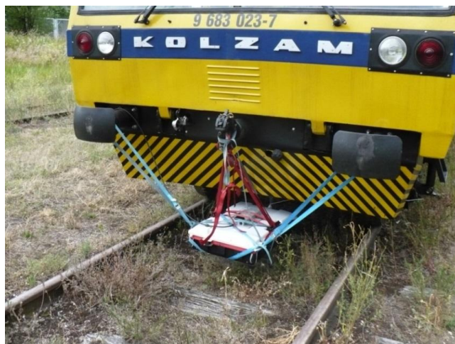
Rys. 4. Sposób mocowania georadaru na drezynie.
