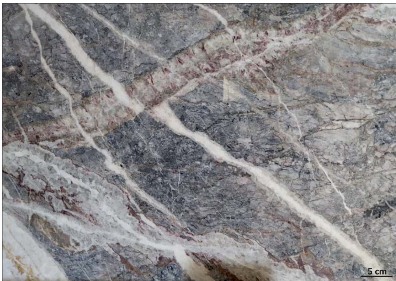
Ryc. 2. Fragment płyty marmuru Fior di Pesco Carnico z widocznym układem licznych, wzajemnie się przecinających żył Fig. 2. Part of a slab of the marble Fior di Pesco Carnico showing the distribution of many mutually intersecting veins
