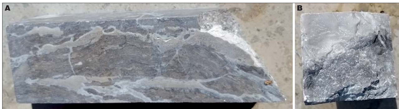
Ryc. 10. Próbką marmuru po wykonaniu badania wytrzymałości na zginanie. Widoczny jest przełam próbki powstały w obrębie żyłki kalcytu. A – widok bocznej ściany próbki, B – powierzchnia przełamu próbki
