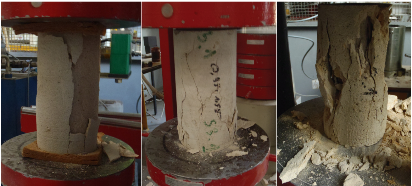
Rys. 5. Badanie wytrzymałości na jednoosiowe ściskanie tworzywa gruntowo-cementowego; źródło: fot. Lidia Wanik, 2016
