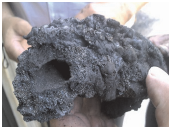
Rys. 7. Osady wydobyte z reaktora fosgenowania Fig. 7. Deposits in phosgenation reactor
