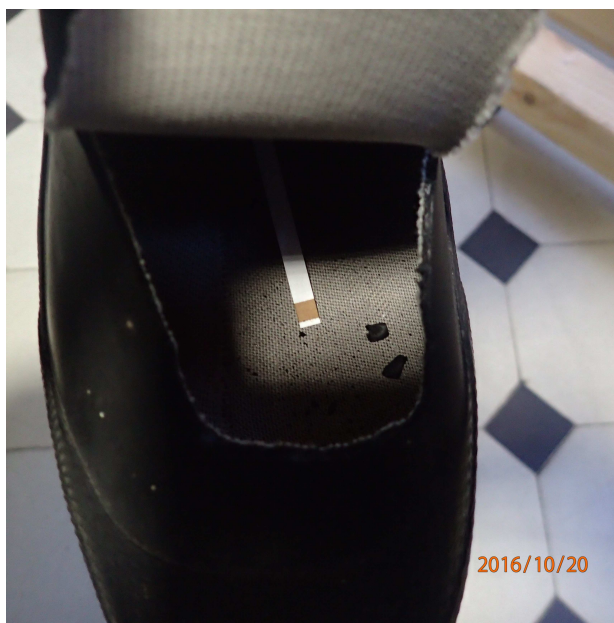
Rys. 3. Rozmieszczenie pasków kontrolnych poziomu H_2O_2 .
