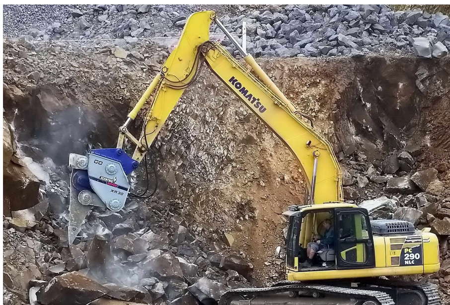
Rys. 19.1 Zrywak wibracyjny XR 42 firmy Xcentric Ripper podczas pracy
