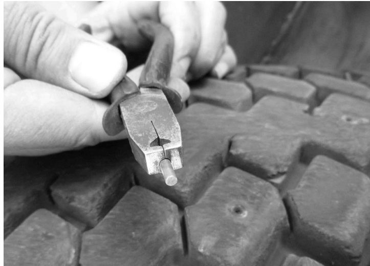
Fig. 4. Pliers for fixing the indicators (rivets) to the tire Рис. 4. Инструмент для установки индикаторов в шине
