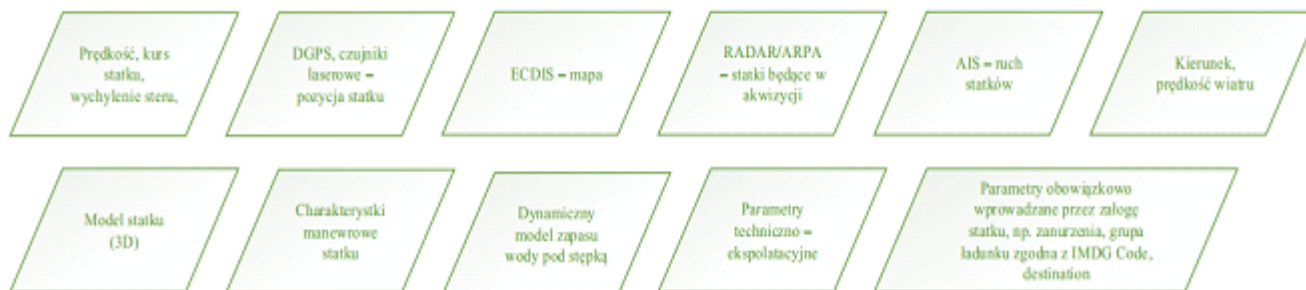
Rys. 10. Wewnętrzne dane wejściowe do modelu szacowania ryzyka manewrowania statkiem
