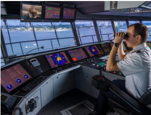
Rys. 5. Konfiguracja systemu INTEGRATED BRIDGE SYSTEMS – przykład [8]
