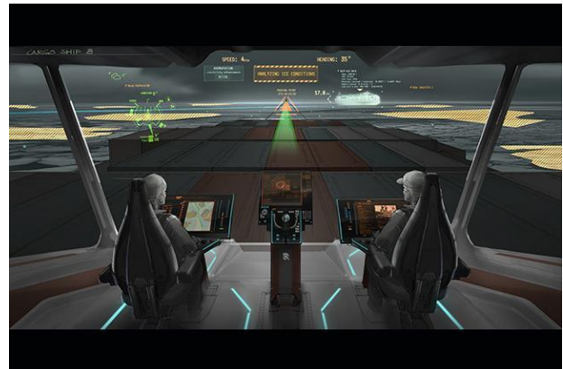
Rys. 7. Sposób wyświetlania informacji nawigacyjnej w rozwiązaniach firmy Rolls Royce [9]
