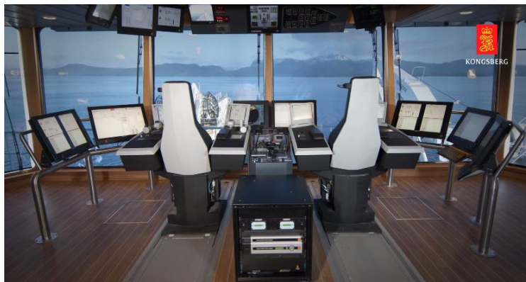
Rys. 6. Przykład konfiguracji systemu K – BRIDGE [6]
