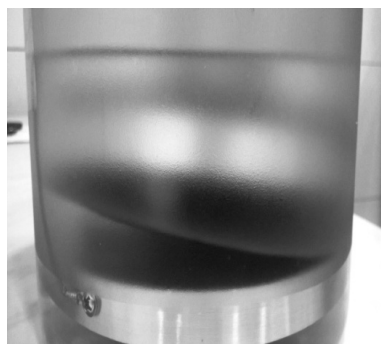
Rys. 3. Naczynie szklane wraz z próbką preszpanową i rozsuniętymi elektrodami – położenie elektrod pomiędzy pomiarami
