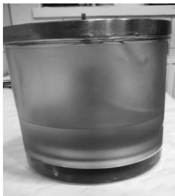
Rys. 1. Szczelne naczynie wraz z próbką preszpanową umieszczoną między elektrodami
