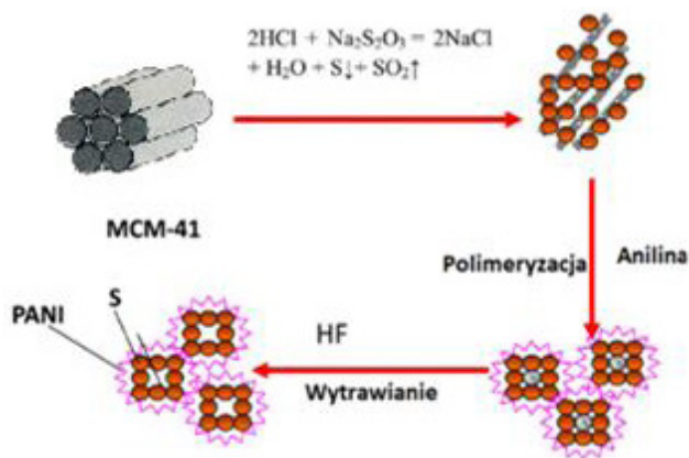
Rysunek 14. Schemat procesu przygotowania kompozytu z polianiliną, siarką i krzemionką [121]
